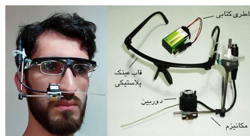
شکل (۳): ردیاب چشم و نحوه نصب بر روی سر
